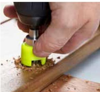
Immobiliser la butée lors du perçage afin d'évacuer rapidement les copeaux et d'éviter de marquer la surface des lames.
