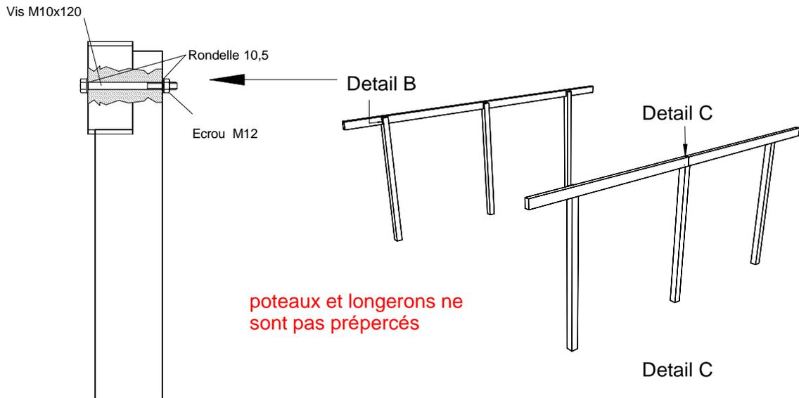
positionnez les 2 longerons sur le poteau et fixez les avec des serre-joints. Avant de percer et de boulonner les poteaux et les longerons, assurez-vous que les poteaux sont dans la bonne position et parfaitement d'aplomb
