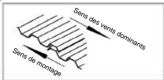
Les plaques en PVC doivent être disposés sur le toit, le recouvrement dans le sens des vents dominants
