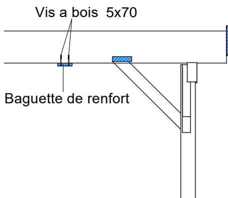
Afin de donner encore plus de stabilité a votre carport, montez maintenant les baguettes de renfort. A cet effet, des baguettes de 90x18 mm d'épaisseur sont vissées sous les pannes avec des vis à bois de 5x70 mm.
