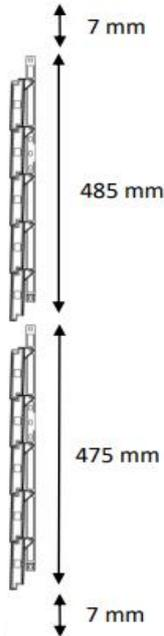
Laissez 7mm au début et à la fin du montage pour l'ouverture optimale des lames. Un mécanisme mesure 485 mm, une perte de 1 cm est à déduire à l'ajout de chaque mécanisme.
