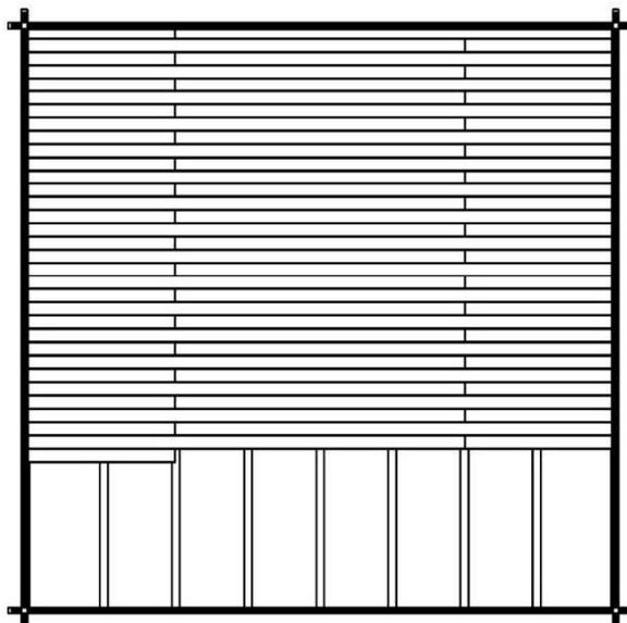
Si les planches du sol (190 cm) sont plus courtes que la profondeur de l'abri, la pose s'effectue selon la méthode de pose TYPE I. Pour savoir quelle longueur est nécessaire, la longueur des planches disposées peut vous orienter. Mesurez longueur manquante à ces planches déjà posées et sciez des lames à la longueur nécessaire. Attention : Les lames doivent se rejoindre au milieu des lambourdes (voir schéma ci-dessus).
