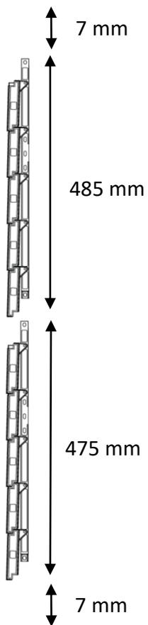
Laissez 7mm au début et à la fin du montage pour l'ouverture optimale des lames. Un mécanisme mesure 485 mm, une perte de 1 cm est à déduire à l'ajout de chaque mécanisme.
