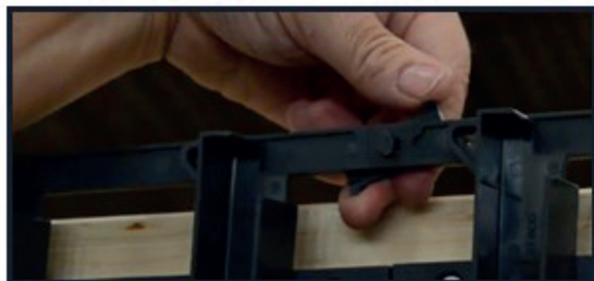
5. Insérer le loquet de verrouillage à l'extérieur des tringles et le faire pivoter dans le sens horaire.
