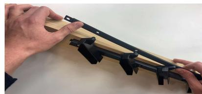
2. Déclipser la tringle PVC des supports de lames à l'aide d'un tournevis. Pour retirer les loquets de verrouillage, s'aider d'une pince.
