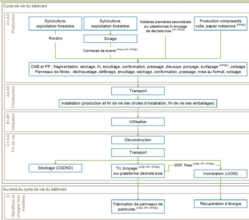
Ce diagramme décrit les processus de l'ACV pour les trois grandes familles de panneaux de process (panneaux OSB, panneaux de fibres, panneaux de particules). Les étapes précisées en exposant sont spécifiques à certaines familles de panneaux (approvisionnement en matières premières, fabrication et fin de vie). Certaines de ces étapes ne sont donc pas considérées dans le cadre de la présente FDES.
