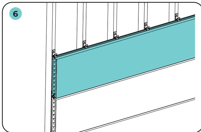
5. Emboîter la lame suivante de la même manière jusqu'en haut de la structure.
