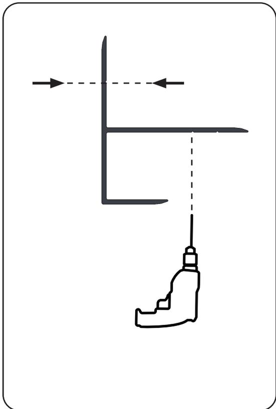
Le profilé angle multifonction peut se percer à différents endroits suivant son utilisation sur le bardage.
