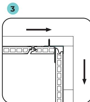
Fixer le profilé d'angle avant la dernière lame du pan de mur. Fixer ensuite la lame avec une vis spécial composite silvadec®
