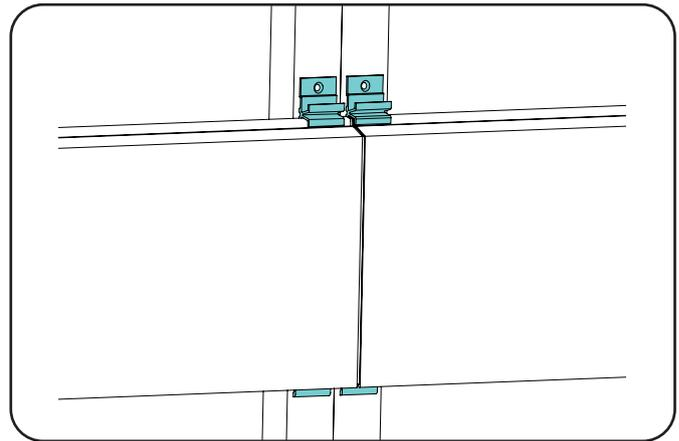
Pour rappel : Les lames doivent être posées sur les tasseaux avec un porte-à-faux maximum de 50mm
