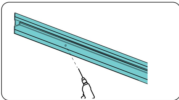
Fixer une grille anti-rongeur afin d'éviter l'intrusion de rongeur derrière le bardage.
