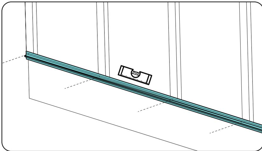
Afin d'éviter la stagnation de l'eau dans la gorge du profilé, percer le profilé entre  $\varnothing 3$  mm et  $\varnothing 5$  mm au niveau de l'aboutage des lames.
