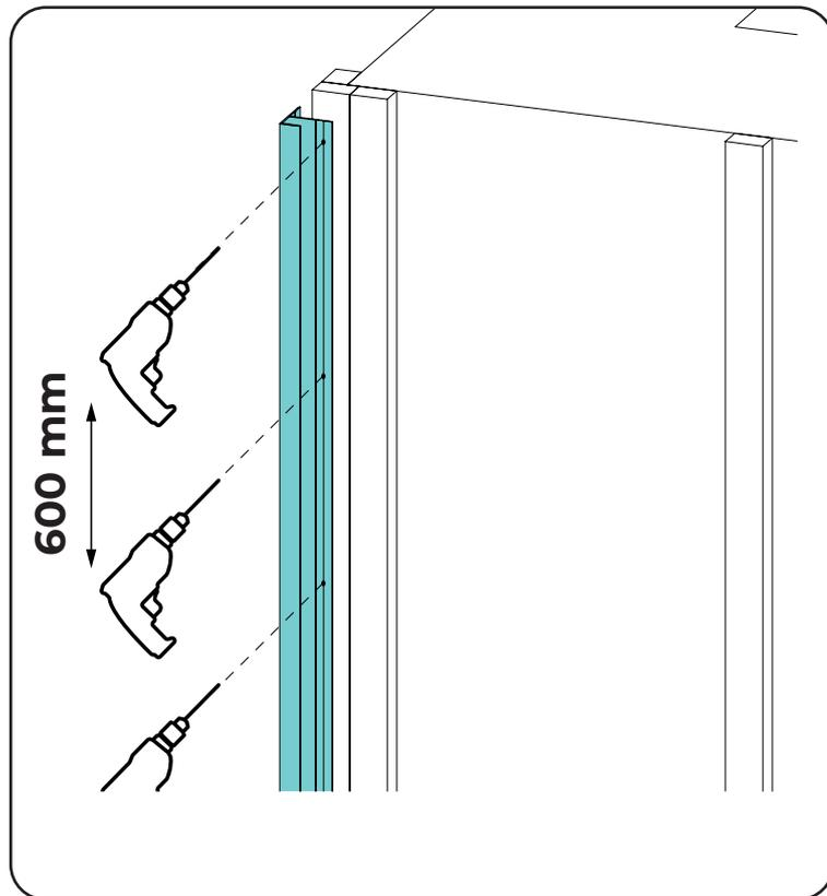
Percer le profilé sur la rainure et le visser sur le tasseau en respectant un entraxe de 600 mm entre chaque vis.
