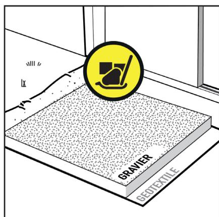
› Réaliser une couche de fondation drainante composée d'un concassé 30/60 ou 40/80.
