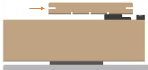
Figure 3 : placez la lame sur l'ossature et faites-la glisser pour insérer les lèvres dans les supports.
