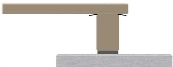
Exemple d'utilisation de bande bitumineuse. Une cale est placée entre la dalle en béton et la lambourde. Une bande d'étanchéité adaptée est placée entre la lambourde et la lame de terrasse.
