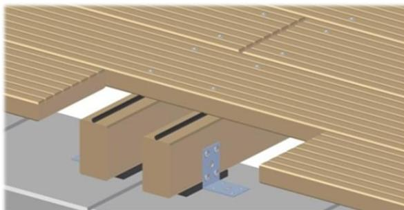
L'aboutage sur deux lambourdes empêche la concentration d'humidité à l'extrémité des lames, pour garantir un bon séchage et réduire les fissures aux extrémités.
