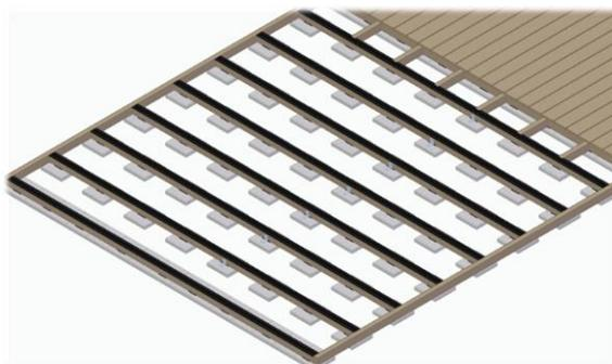
Une bande de protection de lambourde est utilisée entre le platelage et le lambourrage.
