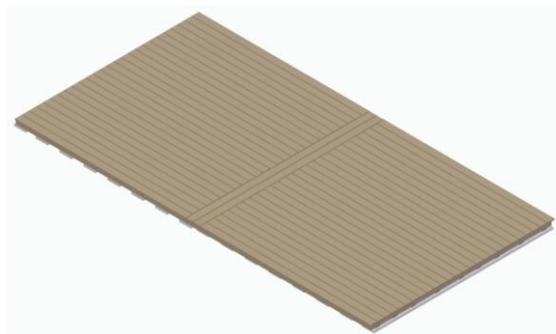
Exemple de division de la terrasse en zones. Ce genre de solutions offre une excellente utilisation du matériau, ainsi qu'une apparence luxueuse. Adaptez la taille des zones à la longueur des lames de terrasse et planifiez l'ossature avant le montage.
