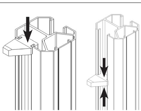
**Etape 2 :** Pour **BLOQUER** la position de la cale, exercer une légère pression sur l'extrémité de celle-ci hors du poteau, puis **DÉPOSER** la lisse basse et la première lame en appui sur la cale de réglage. **RÉGLER** ensuite le niveau en déplaçant la cale vers le haut ou vers le bas. **VERROUILLER** ensuite la position de la cale en exerçant une légère pression sur la lame.
