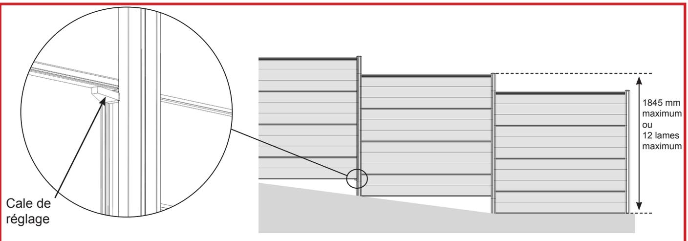
**Etape 1 : INSÉRER** la cale réglable dans la gorge du poteau, puis la glisser le long du poteau jusqu'à la hauteur souhaitée en appuyant sur la surface plane intérieure au poteau (cf. schéma ci-contre).
