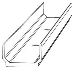
**C111. INSÉRER** la lisse basse dans l'ouverture de la platine, en appui contre le poteau.
