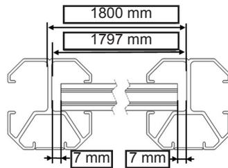
**B4. SCELLER** les poteaux avec du béton tout en prenant soin de vérifier la verticalité (à l'aide d'un niveau), la hauteur et l'entraxe des poteaux, lors du remplissage des trous. Après séchage, révérifier la cote de 1800 mm.
