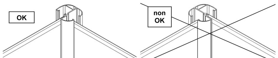
**ATTENTION** : lors de la pose de claustras avec poteaux d'angle, il est **IMPÉRATIF** d'habaner les poteaux pour une résistance accrue au vent (au delà de 90km/h).
