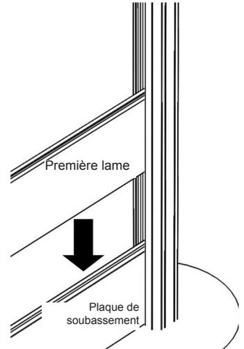
**C121.** Une fois le béton solidifié, **INSÉRER** la plaque de soubassement dans la gorge du poteau, et la faire reposer sur le socle en béton.
